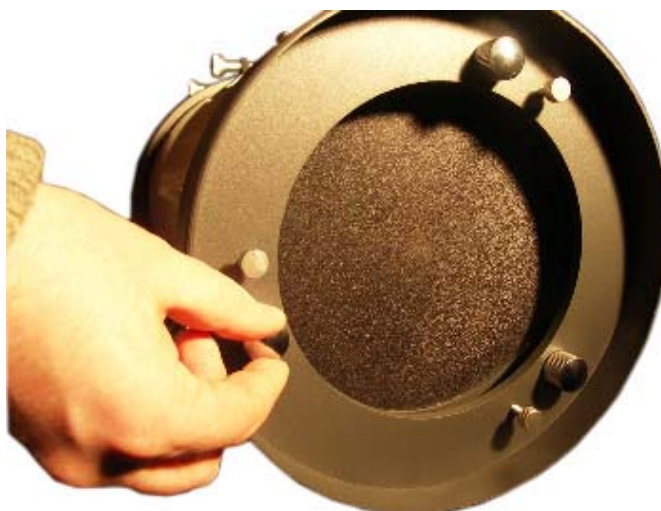
Rys. 11 Regulacja pozycji lustra głównego
