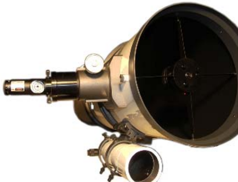
Rys. 7 Kolimator założony w wyciągu okularowym w pozycji właściwej do kolimacji lusterka wtórnego
