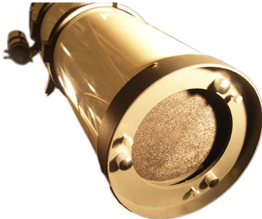
Rys. 10 Widok na śruby regulacyjne (duże) i śruby kontruujące (małe) w oprawie lustra głównego (widok od tyłu teleskopu)
