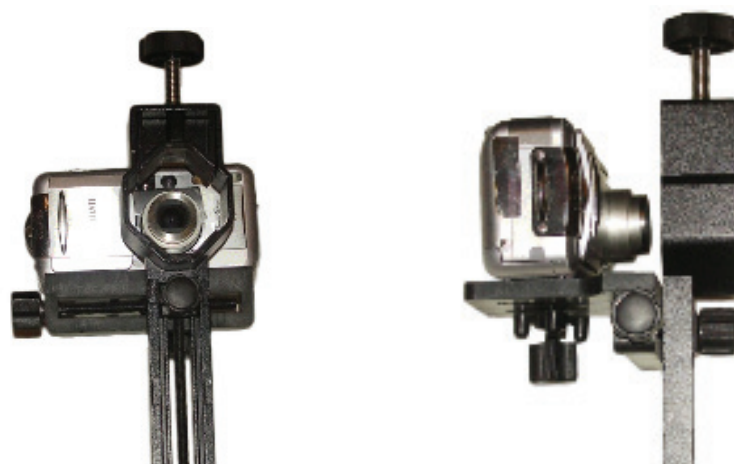
Rys. 2 Aparat kompaktowy zamocowany na półeczce adaptera
